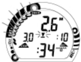
Fig. 56 - Modo Infraccion diferida 1
