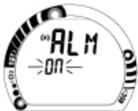
Fig. 32 - Ajuste de la alarma acustica
