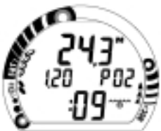
Fig. 47 - Sin descompresion Pantalla alterna 2
