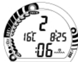
Fig. 60 - Violacion inmediata / Modo profundimetro (superficie)
