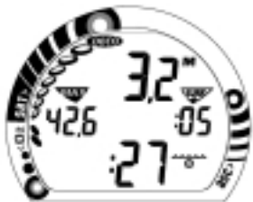
Fig. 52 - Con descompresion Pantalla alterna 1
