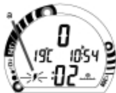
Fig. 20 - Superficie (batería baja)
