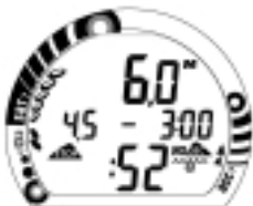
Fig. 48 - Sin descompresion Parada de seguridad
