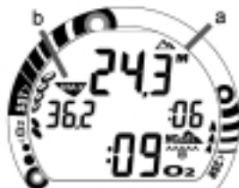
Fig. 3 - Profundidad Actual y Profundidad Máxima
