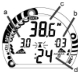
Fig. 49 - Entrada en modo descompresion
