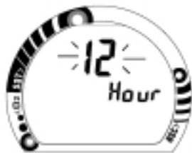
Fig. 29 - Ajuste del formato horario
