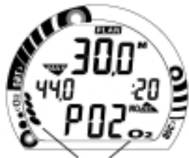
Fig. 43 - Calculo controlado por el Oxigeno
