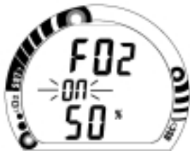
Fig. 36 - Ajuste del valor predeterminado de 50% del FO2
