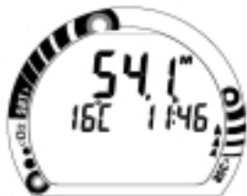
Fig. 65 - Modo profundimetro Pantalla alterna
