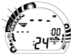
Fig. 58 - Modo Infracción diferida 3
