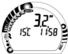
Fig. 53 - Con descompresion Pantalla alterna 2
