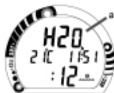
Fig. 19 - Modo de superficie (instrumento humedo)
