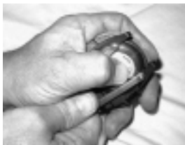
Fig. 88 - Bloqueo del tornillo (llave de compás)
