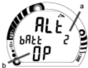
Fig. 17 - Altitud y el nivel de carga
