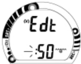
Fig. 26 - Ajuste de la alarma de tiempo de inmersión transcurrido
