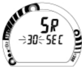
Fig. 38 - Ajuste del intervalo de registro de datos
