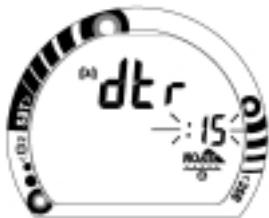
Fig. 34 - Ajuste de la alarma de tiempo de inmersión restante
