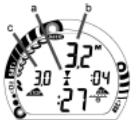
Fig. 50 - Parada de descompresion
