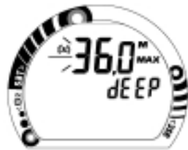
Fig. 25 - Ajuste de alarma de profundidad maxima
