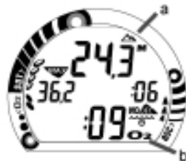
Fig. 45 - Sin descompresion Pantalla principal
