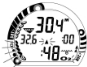
Fig. 63 - O2 en zona peligrosa
