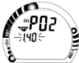
Fig. 35 - Ajuste de la alarma de maximo PO2
