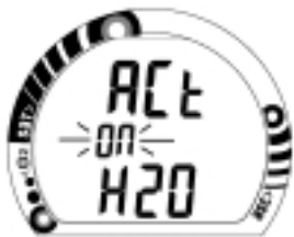
Fig. 40 - Ajuste de la activación por inmersión
