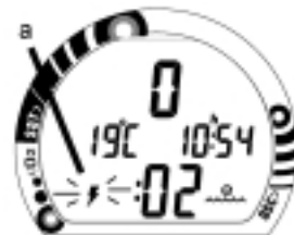
Fig. 8 - batería baja (reemplazar)
